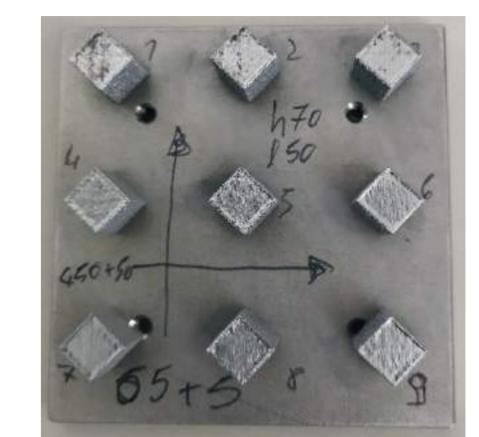
Test using Simplify slicer Hatching = 70 um Layer = 50 um
